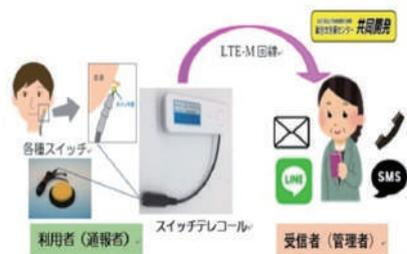
外部スイッチをジャックに接続してすぐに使える携帯型通報サービス。通報をLINEや電話で受信できます。
