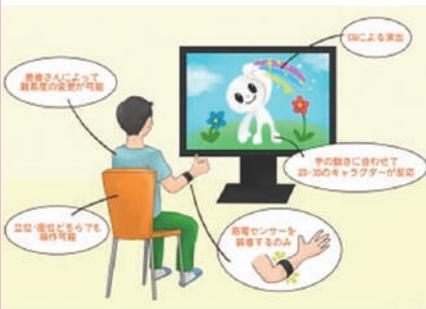
身体運動を介してCG上のアバターを操作するゲームシステム。障害レベルに応じた操作性の変更が可能。
