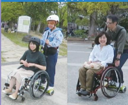
バランススクーターや電動スケボーを手動車いす後部に取り付け駆動装置にした電動化ユニットです。
